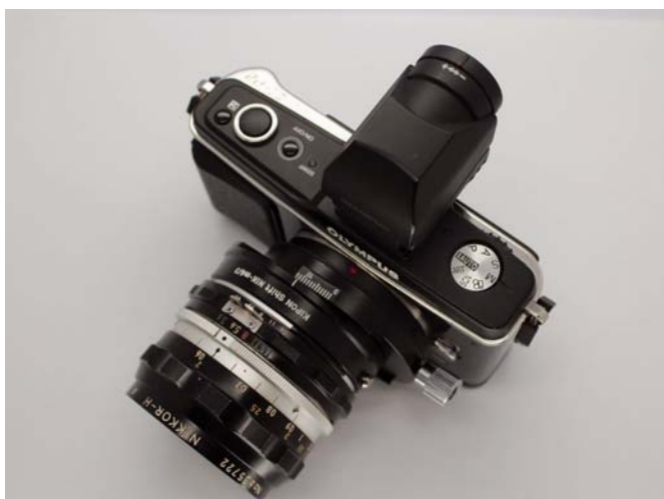
Különleges adapter, amely eltolható (tilt) objektívet varázsol egy hagyományos darabból. Az objektív full frame méretű képkört rajzol ki, így még eltolva is megfelelő a jóval kisebb 4/3-os képszenzorhoz
