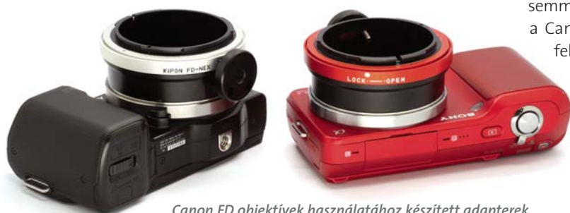
Canon FD objektívek használatához készített adapterek Sony NEX fényképezőgépeken
