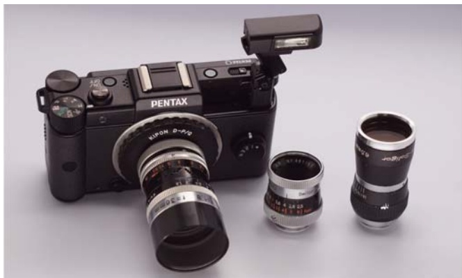
Az eredetileg a 8 mm-es filmfelvevőkhöz készített D-csatlakozású objektívek jól használhatók konverter segítségével az apró szenzorméretű Pentax Q fényképezőgépeken
